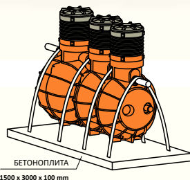
ВАРИАНТ УСТАНОВКИ С БЕТОННОЙ ПЛИТОЙ
